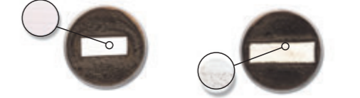
Microban®配合によりカビの発生を抑制 従来のペイントではカビが発生
